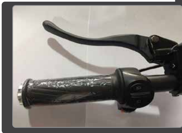
Η αριστερή λαβή φρένου για το φρένο του πίσω τροχού
